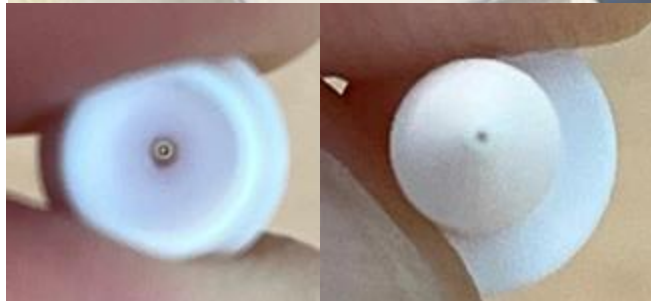
Сопла для струйной печати с размером отверстия 180 мкм (пример изготовления на модифицированном принтере Crealty Halot Mage 8K)
